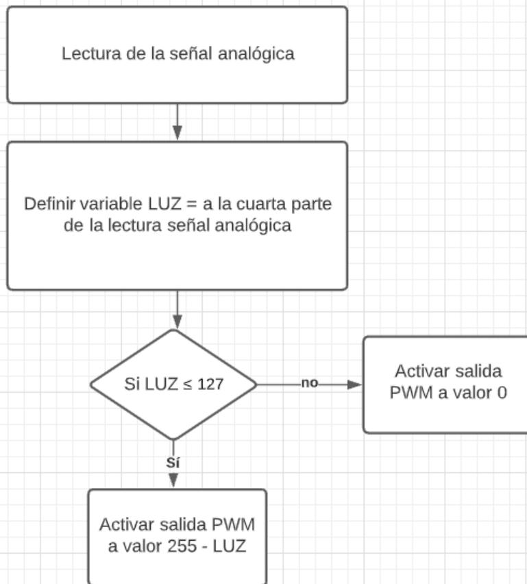
Este programa realizado en línea con el simulador Tinkercad tiene encendido el LED cuando está oscuro y va apagándolo a medida que aumenta la luz. Siempre con un valor definido para apagar la iluminación
