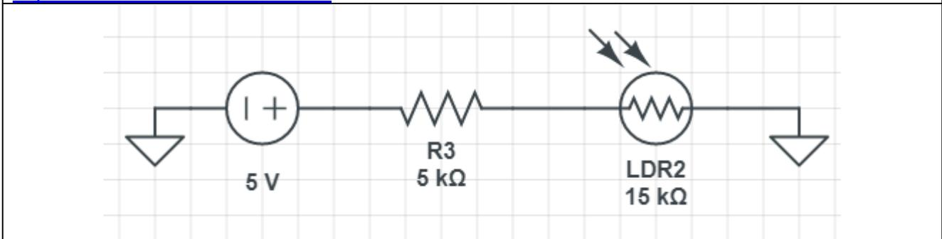
Circuito divisor de tensión con una LDR aplicando la tensión variable a la base de un transistor. Dibujado con el programa on line <https://www.circuitlab.com/editor/#>
