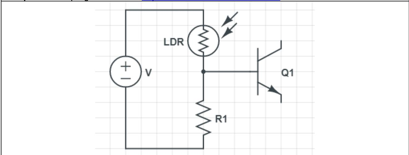
Circuito electrónico con el que se detecte la variación de la luz y para un valor determinado de oscuridad enciende una lámpara. Circuito dibujado con el programa on line <https://www.circuitlab.com/editor/#>
